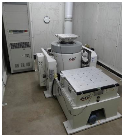
振動試験機本体
